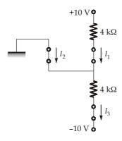
$$I_1 = I_3 = \frac{10 - (-10)}{8k\Omega} = \frac{20}{8k\Omega} = 2.5 \text{ mA}$$
