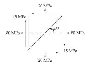
$\sigma_x=80$  MPa,  $\sigma_y=20$  MPa,  $\tau_{xy}=-15$  MPa,  $\theta=45^\circ$
