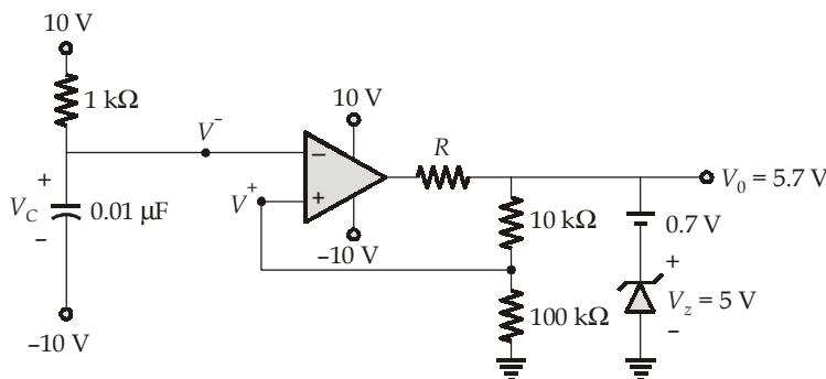
$$V^+ = V_0 \times \frac{100 \text{ k}\Omega}{(10 + 100) \text{ k}\Omega}$$
