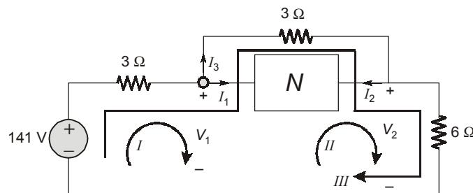
$$\begin{bmatrix} V_1 \\ V_2 \end{bmatrix} = \begin{bmatrix} 2 & 1 \\ 1 & 4 \end{bmatrix} \begin{bmatrix} I_1 \\ I_2 \end{bmatrix} \Rightarrow V_1 = 2I_1 + I_2 \\ V_2 = I_1 + 4I_2$$
