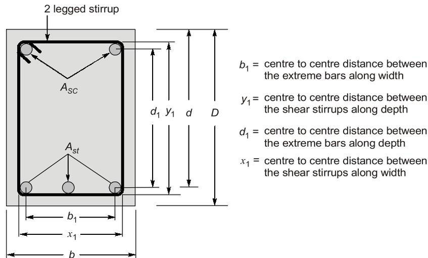
**Fig. Stirrups in beams**
